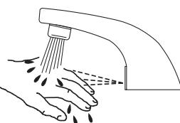
3. Cuando las manos se retiran del Sensor OPTIMA®, la pérdida de luz reflejada inicia una señal eléctrica que desactiva la Válvula Solenoide, cerrando el flujo de agua. Entonces, el Circuito se restaura automáticamente y está listo para el siguiente usuario.
